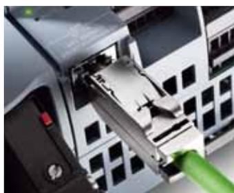
集成的 PROFINET 接口用于编程、HMI 通信和 PLC 间的通信。此外它还通过开放的以太网协议支持与第三方设备的通信。该接口带一个具有自动交叉网线（auto-cross-over）功能的 RJ45 连接器，提供 10/100 Mbit/s 的数据传输速率，支持以下协议：TCP/
